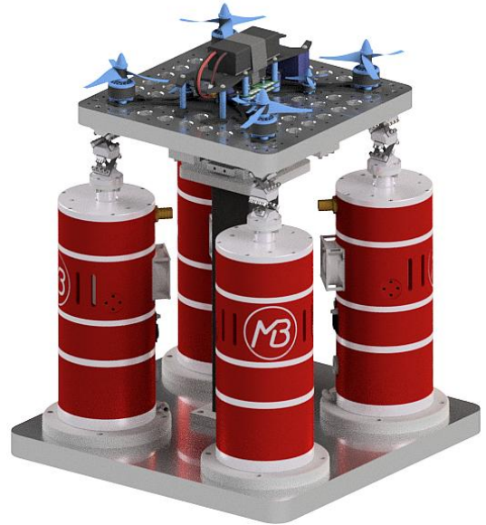
Bild 1: Der äußerst kompakte Vertical Pitch-Roll Schwingtisch VPR 2825 ermöglicht die simultane Anregung von Prüflingen mit einem Gewicht von bis 300kg in bis zu 5 Achsen und zeichnet sich durch seine Vielseitigkeit und geringen Platzbedarf aus.
