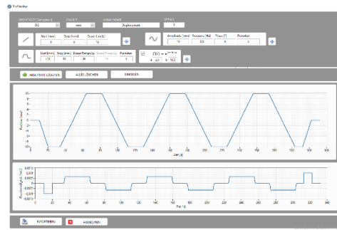
Bild 4: Definition eines rampenförmigen Bewegungsprofils
