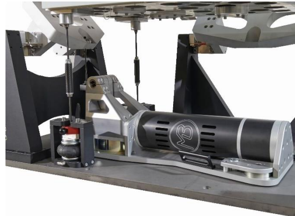
Bild 1: Verfahrbarer ALPHA MLB Shaker zur Anregung des 3D Schwingtisches in x-, y- und z-Achse ermöglichen die einfache und schnelle Umrüstung der Anregungsrichtung ohne Demontage des Prüflings.
