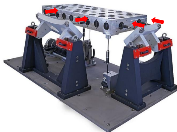
Bild 3: Führungs- und Übertragungsarme stellen eine synchrone Anregung und Führung des Magnesium-Schwingtisches in allen drei Anregungsachsen sicher.
