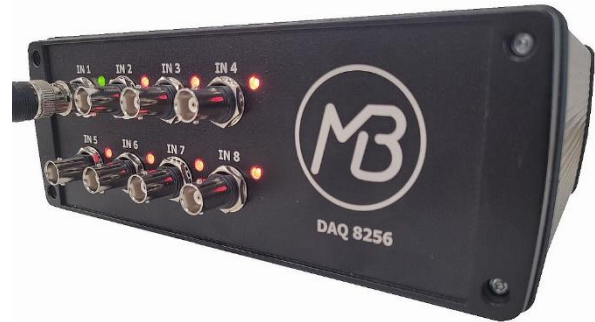
Bild 1: Status-LEDs für jeden Analogeingang zeigen an, ob der Eingang offen, die IEPE-Sensorstromversorgung aktiviert ist oder eine Übersteuerung des Eingangskanals vorliegt.
