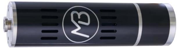
*Bild 1: Mit einem Gewicht von gerade einmal 39kg und einem Durchmesser von 198mm erzeugt der ALPHA 3025 MK2 Anregungskräfte von 3000N Sinus Peak und kurzzeitige Spitzenkräfte von bis zu 6000N Peak. Ein zentrisches M12-Gewinde ermöglicht die einfache Anbindung an verschiedenste Prüftische und Strukturen.*
