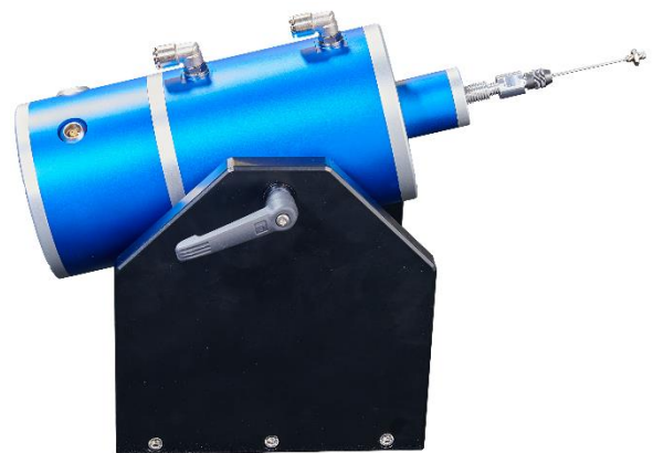
Bild 2: X-Act 325 Schwingererreg mit Spannzange & Stinger für Modalanalysen
